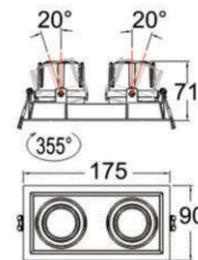
Cet **encastré orientable** remplacera parfaitement un encastré halogène classique. Il se décline en simple et double.
